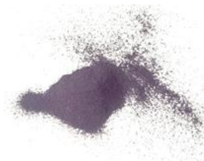
Рисунок 24. Фотография осадка, полученного при плотности тока 0,2 \text{ A/cm}^2 в расплаве \text{CaCl}_2 + 15 \text{ масс. \% B}_2\text{O}_3 + 5 \text{ \% La}_2\text{O}_3
