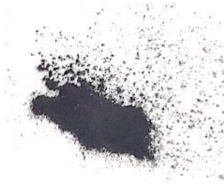
Рисунок 34. Фотография продукта электролиза, полученного при плотности тока 0,2 \text{ A/cm}^2 в расплаве \text{CaCl}_2 + 15 \text{ масс. \% B}_2\text{O}_3 + 5 \text{ \% Gd}_2\text{O}_3
