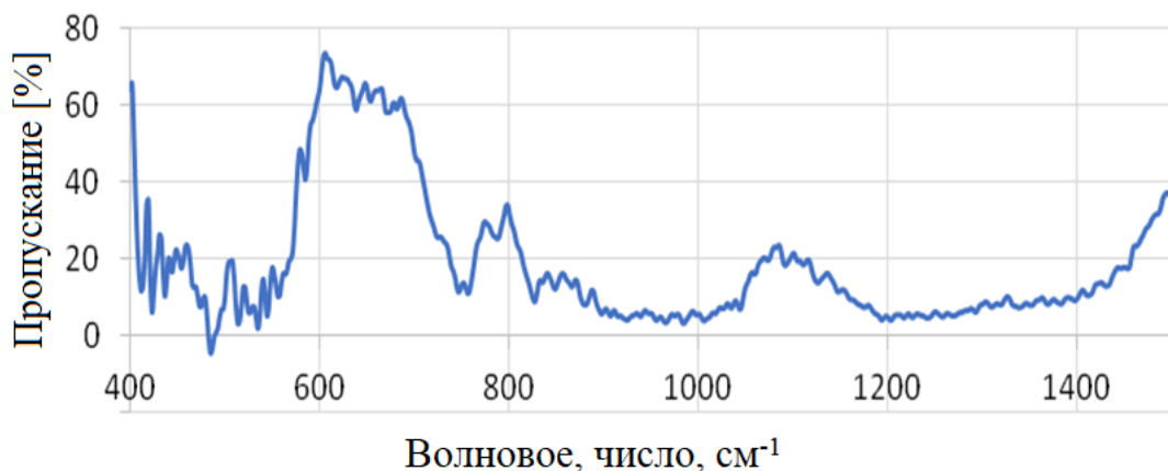
Рисунок 6. ИК-спектр застывшего расплава CaCl_2 безв – CaO - B_2O_3 - Gd_2O_3
