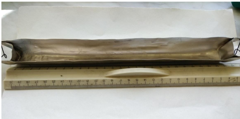
Рисунок 1.7 – Молибденовая лодочка для очистки солей методом направленной перекристаллизации
