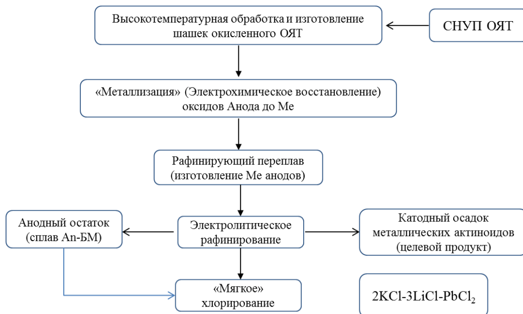
Рисунок 1 – Технологическая схема комбинированной переработки СНУП ОЯТ
