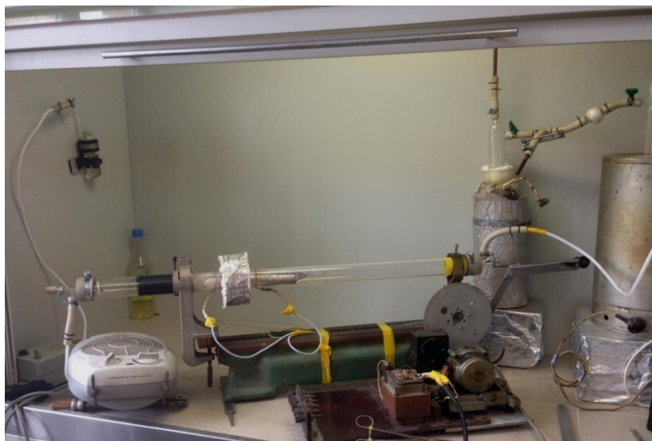
Рисунок 1.8 – Установка очистки солей методом направленной перекристаллизации
