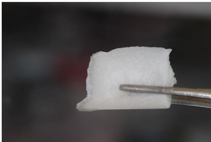
Рисунок 1.10 – Хвостовая часть слитка, обогащенная примесями
