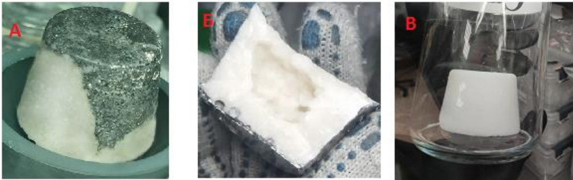
Рисунок 2.7 – Фотографии охлажденного плава соли LiF-NaF-KF после очистного электролиза с висмутом на дне (А, Б) и переплавленного (В)
