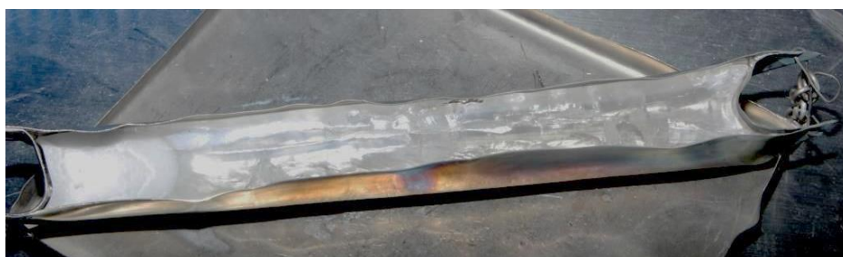
Рисунок 1.5 – Фотография лодочки с застывшим плавом фторида калия после очистки методом зонной плавки
