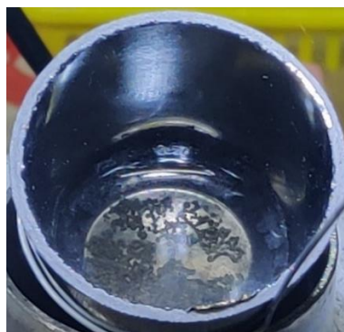
Рисунок 4.13 – Фотография расплава LiF-NaF-KF-CeF 3 после добавки Li 2 O
