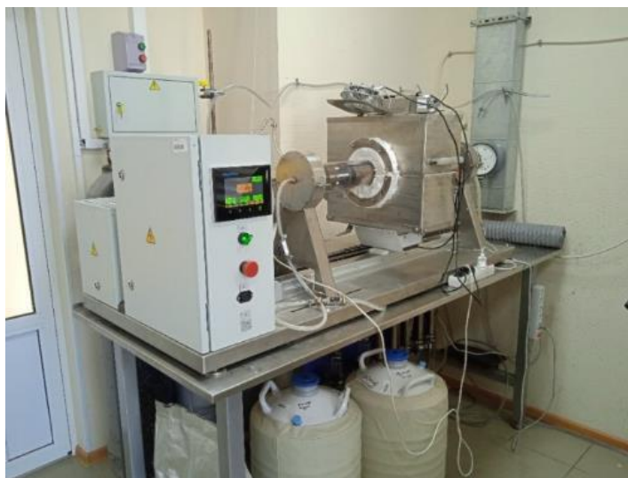
Рисунок 1.6 - Внешний вид установки для проведения зонной плавки индивидуальных солей хлорида калия и лития
