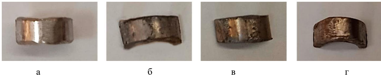
Рисунок 1.9 - Внешний вид образцов стали 12X18H10T до и после 100-часовых определения коррозионных характеристик:
