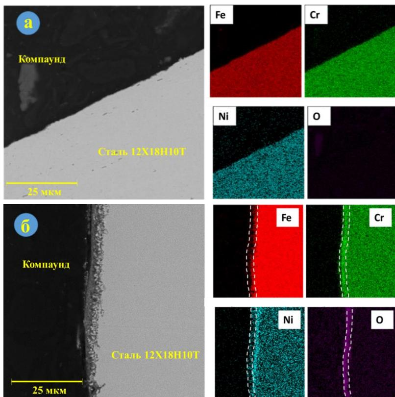
Рисунок 3 – Картирование шлифа поперечного сечения образца 12X18H10T, выдержанного в расплаве LiCl-KCl в течение 100 часов.
