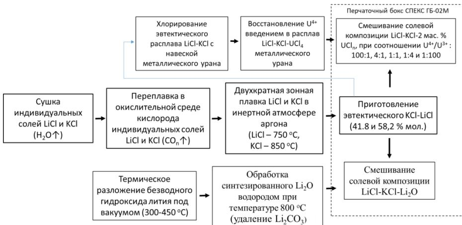
Рисунок 1 – Схема получения используемых солевых композиций на основе LiCl-KCl
