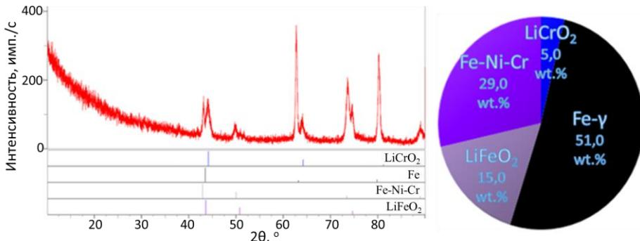
Рисунок 6 – Результаты РФА образцов стали после коррозионной выдержки в расплаве  $\text{LiCl-KCl-2$  мас. %  $\text{Li}_2\text{O}$
