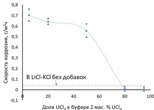
Рисунок 9 – Зависимость скорости коррозии образцов стали 12Х18Н10Т, выдержаных в расплаве  $\text{LiCl}-\text{KCl}-2 \text{ мас. \% UCl}_n$ , от доли трехвалентного хлорида урана
