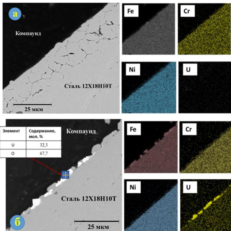
Рисунок 10 – Результаты МРСА шлифов поперечного сечения образцов стали 12Х18Н10Т, выдержаных в солевой композиции  $\text{LiCl}-\text{KCl}-2 \text{ мас. \% UCl}_n$ .
