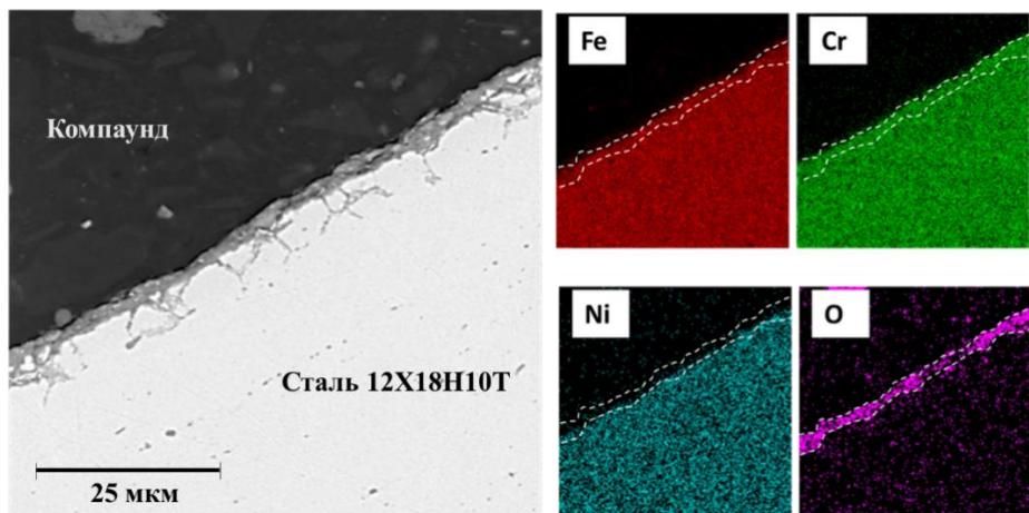
Рисунок 5 – Морфология образцов стали после коррозионной выдержки
