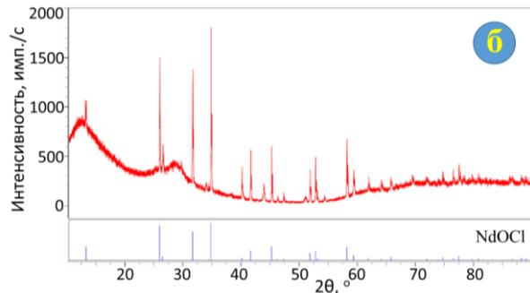
Рисунок 8 – Пример образования оксихлоридного слоя (расплав LiCl-KCl-2 мас. % NdCl<sub>3</sub>) в окислительной газовой атмосфере в результате коррозионной выдержки образцов стали 12Х18Н10Т течение 100 часов.
