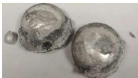
Рисунок 3.25 – Алюминий со дна электролизера после электролиза расплава KF-NaF-AlF<sub>3</sub>-Al<sub>2</sub>O<sub>3</sub> при 800°C
