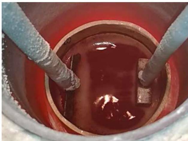
Рисунок 3.24 – Электролиз расплава KF-NaF-AlF<sub>3</sub>-Al<sub>2</sub>O<sub>3</sub> при 800°C
