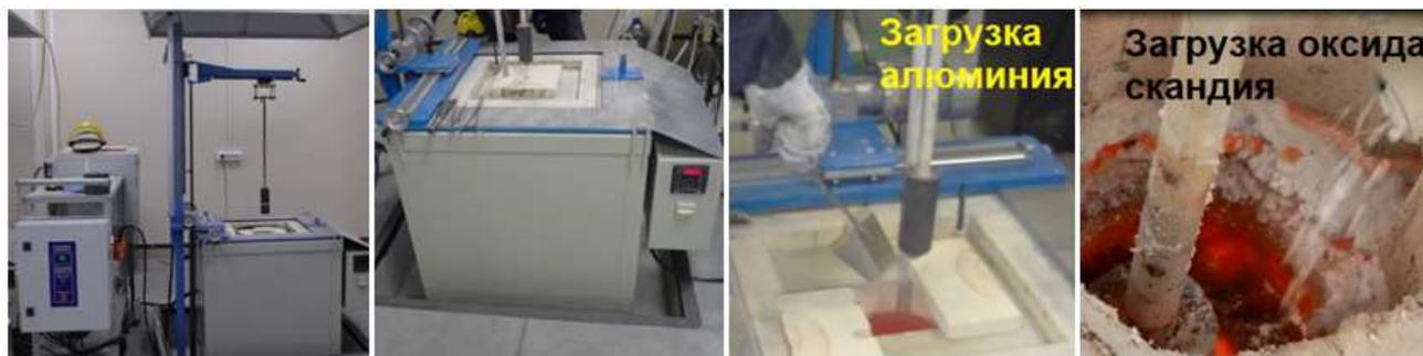
Рисунок 5.20 – Фотографии укрупненного лабораторного электролизера для электролиза расплавов  $\text{KF-NaF-AlF}_3\text{-Al}_2\text{O}_3\text{-Sc}_2\text{O}_3$
