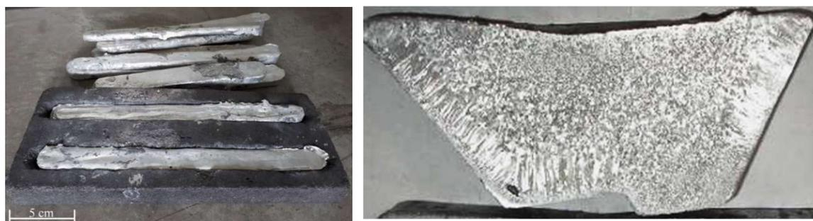
Рисунок 5.21 – Типичные отливки лигатуры Al-Sc в графитовой изложнице и после рекристаллизации
