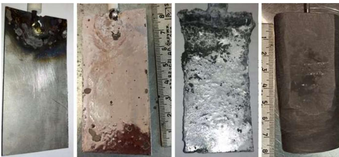
Рисунок 3.23 – Фотографии электродов: катод до алититрования, катод после алититрования, катод после электролиза, графитовый анод
