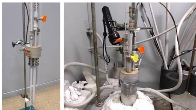
Рисунок 2.5 – Фотографии экспериментальной ячейки для исследования фазовых равновесий в системах \text{LiCl-KCl-Li}_2\text{O} методом «кривых охлаждения»
