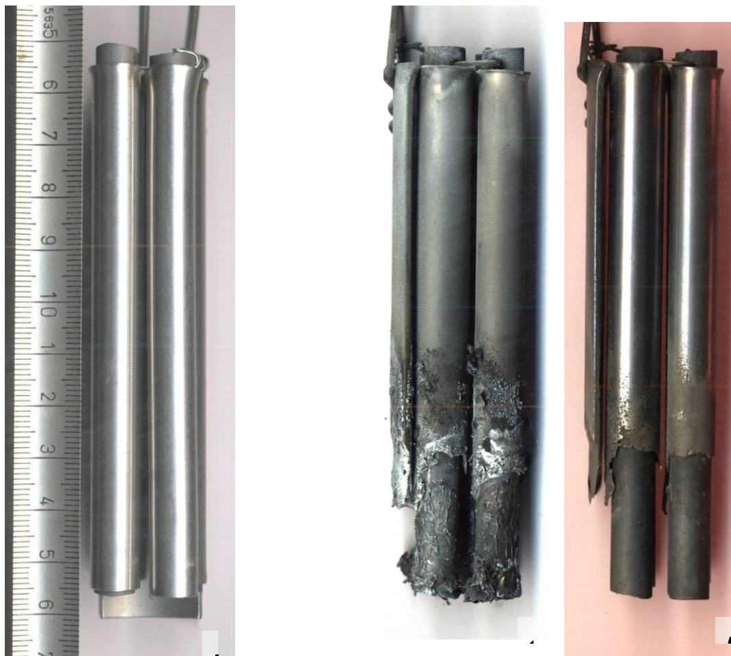
Внешний вид «модельной сборки» реакторов типа БРЕСТ и БН из 4-х трубок (сталь) с графитовыми сердечниками (имитатор топлива). Температура 750 °С. Время выдержки 2 часа. а) до опыта; б, в) после опыта.
