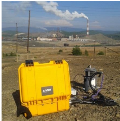
Система для измерения почвенного дыхания в полевых условиях LiCor-8100A
