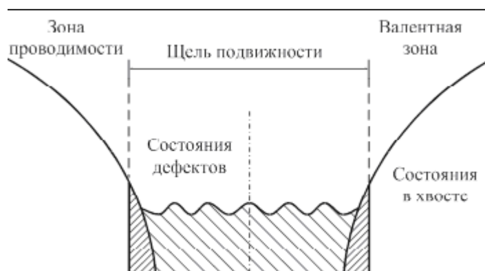
Рисунок 1.9 – Диаграмма плотности состояний аморфного полупроводника [50].
