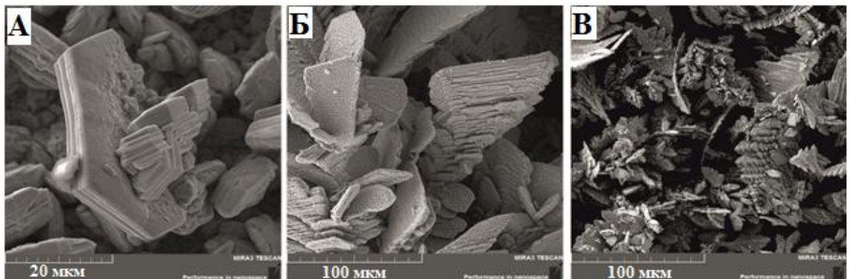
Рисунок 4.28 – Морфология рыхлых осадков цинка, полученных в импульсных режимах 3/15 ( k = 3,3 ) (А), 1/1 ( k = 1,1 ) (Б) и 15/15 ( k = 16,7 ) (В). Q = 30 Кл
