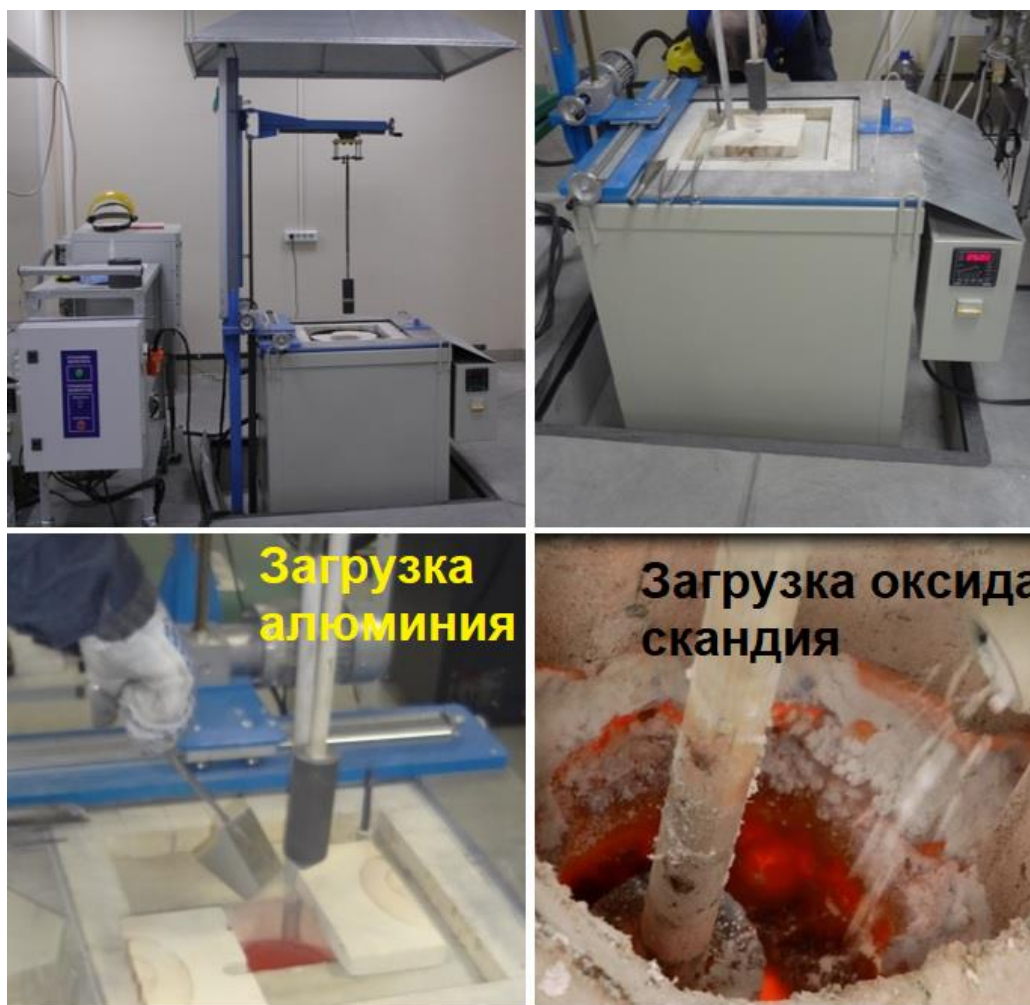
Рисунок 3.15 – Фотографии укрупненного лабораторного электролизера для непрерывного электролитического получения лигатуры Al-Sc
