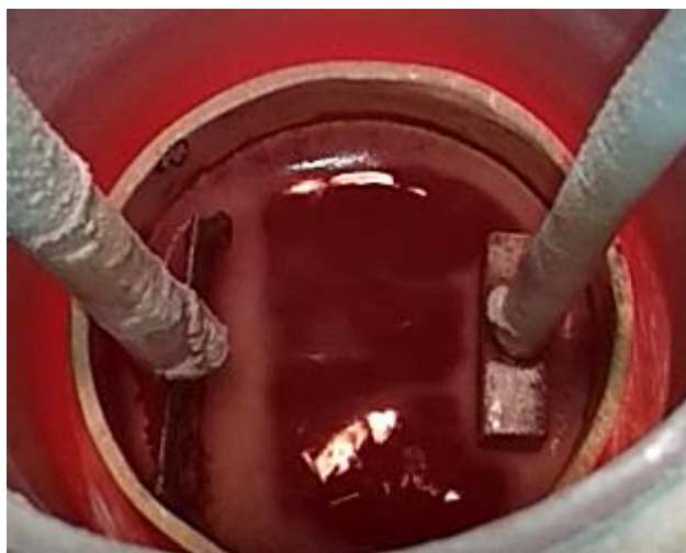
Рисунок 1.10 – Фотография электролизера для электролизных испытаний легкоплавких электролитов
