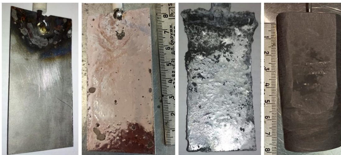
Рисунок 1.11 – Фотографии слева направо: W катод до алитирования, W катод после алитирования; W катод после электролиза расплава \text{KF-AlF}_3\text{-Al}_2\text{O}_3 при 750\text{ }^\circ\text{C} и i_k=0,45\text{ A/cm}^2 ; графитовый анод (марка МПГ-8)
