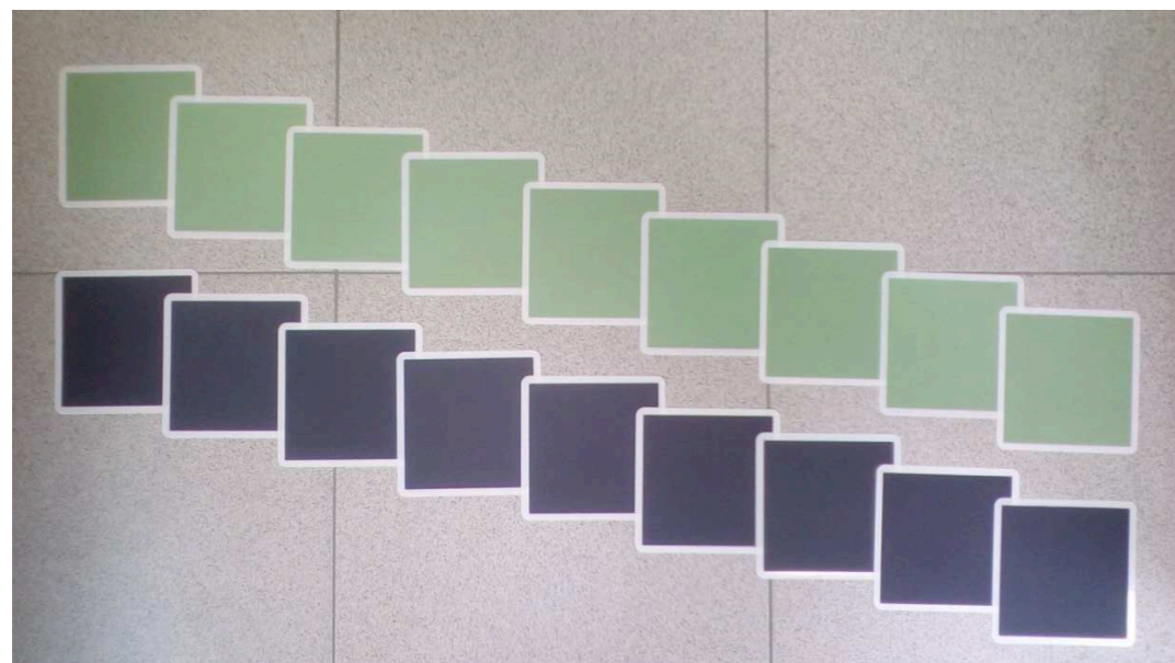
Рисунок 1. Мембранно-электродные блоки ТОТЭ, изготовленные методом совместного спекания электродов.
