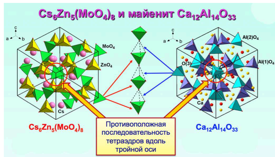
Рисунок 2. Структура \text{Cs}_6\text{Zn}_5(\text{MoO}_4)_8 в сравнении с майенитом.
