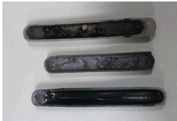
Рисунок 2. Вид поверхности шлака после обработки расплава аргоном (средняя лодочка).
